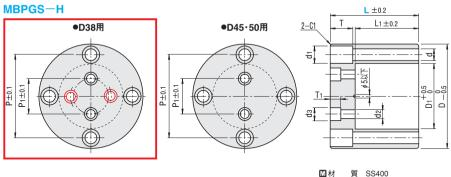
S表面処理 四三酸化鉄皮膜 (Fe3O4)
